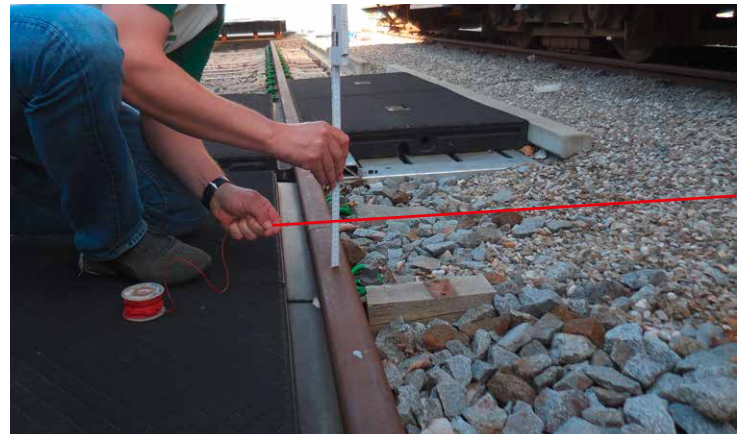
Höhenunterschied der Gleise zueinander messen
